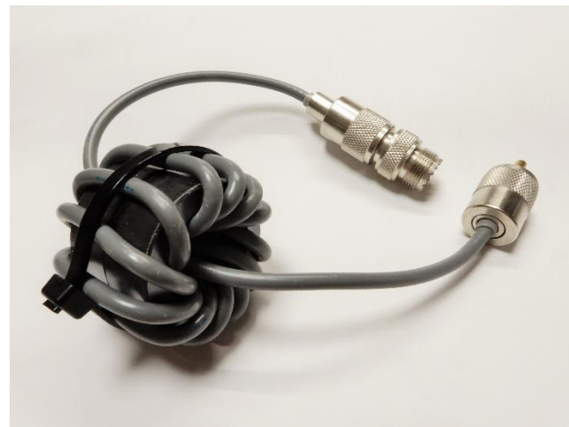
同軸ケーブルのノイズ対策 （コモンモードチョーク、 大進無線のキットを使用）
